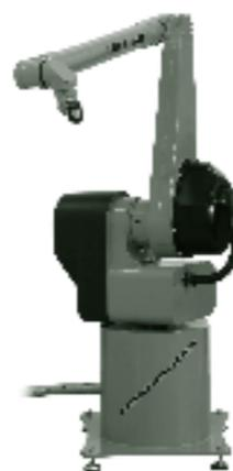
Foto 3.6. Robot de pintura. Fuente: Mercury Dos
