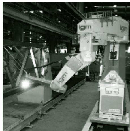
Foto 3.5 Celda robotizada de soldadura con volteado horizontal. Fuente: IRUÑA/IGM
