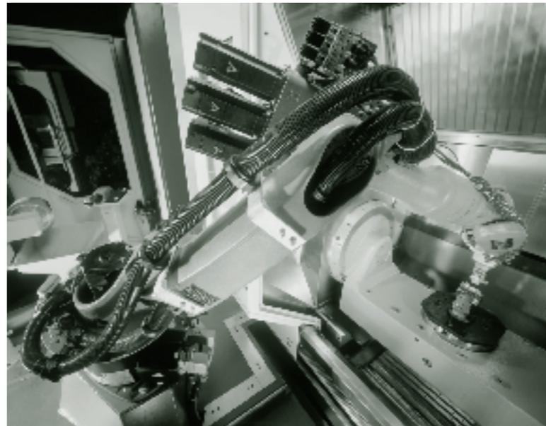
Foto 3.1. Robot antropomórfico alimentando una máquina de mecanizado. Fuente: Berthold Hermle AG
