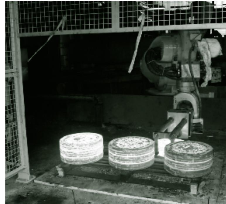
Foto 3.2. Manipulación robotizada en un proceso de fundición de metales. Fuente: INALI
