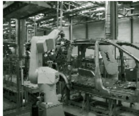
Foto 3.11. Robots con cabezal de inspección incorporado.
