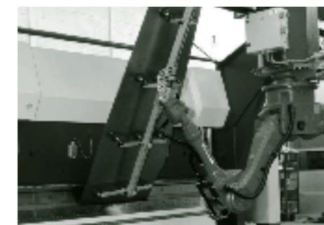
Foto 3.8. Robot utilizado en tareas de plegado de hojas de chapa metálica. Fuente: YASKAWA
