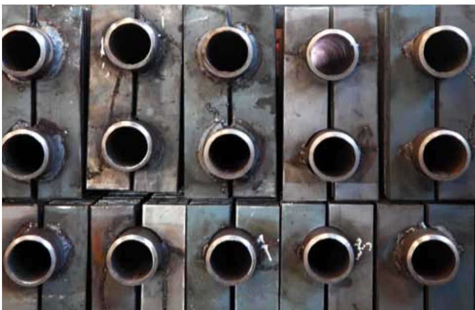
Detalle de las tuberías de un economizador para caldera de vapor.
