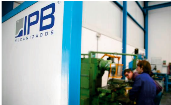
En el interior de la nave, tres operarios manejan los tornos y la fresadora, una moderna maquinaria específica para la mecanización
