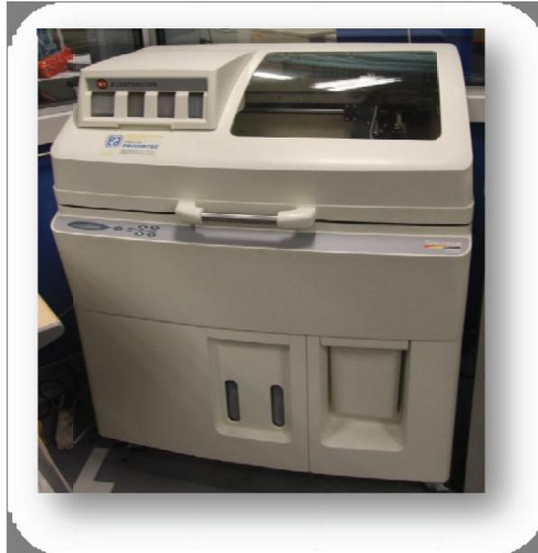
*Ilustración 22: Máquina ZCorp 510 disponible en las Instalaciones de la Fundación PRODINTEC.*
