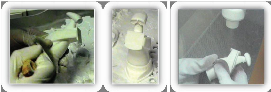
*Ilustración 56: Proceso de limpieza y granallado de la pieza*
