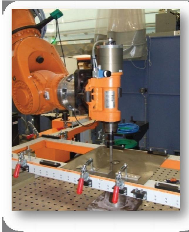
*Ilustración 39: Brazo robotizado accionando presión sobre la plancha metálica en las instalaciones de la Fundación PRODINTEC.*
