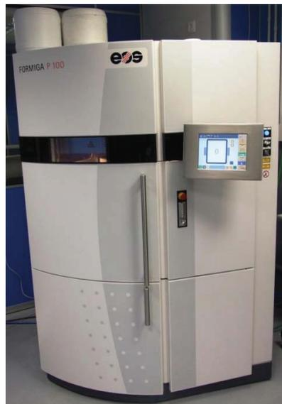
*Ilustración 10: EOSINT-P100, en las instalaciones de la Fundación PRODINTEC, cuya cuba de trabajo 245 x 240 x 330 mm*
