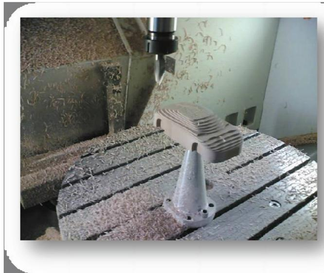
*Ilustración 29: Proceso de desbaste inicial. Cortesía de la Fundación PRODINTEC.*
