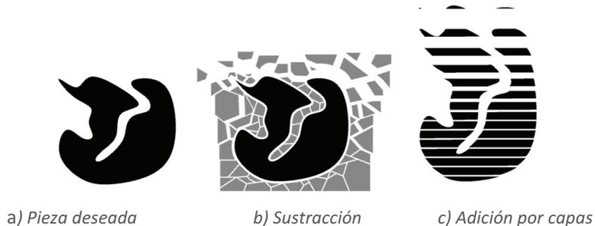
*Ilustración 5: Concepto de fabricación sustractiva comparado con AM*
