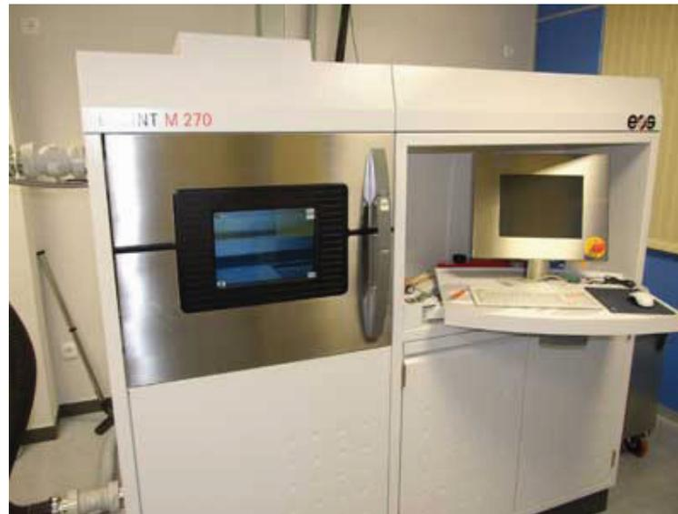
*Ilustración 15: Máquina de Sinterizado laser metálico EOS-M270, en las instalaciones de la Fundación PRODINTEC*
