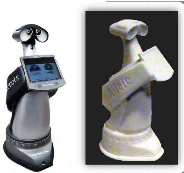
*Ilustración 55: Robot TICO (Modelo real). Pieza fabricada por tecnología AM*
