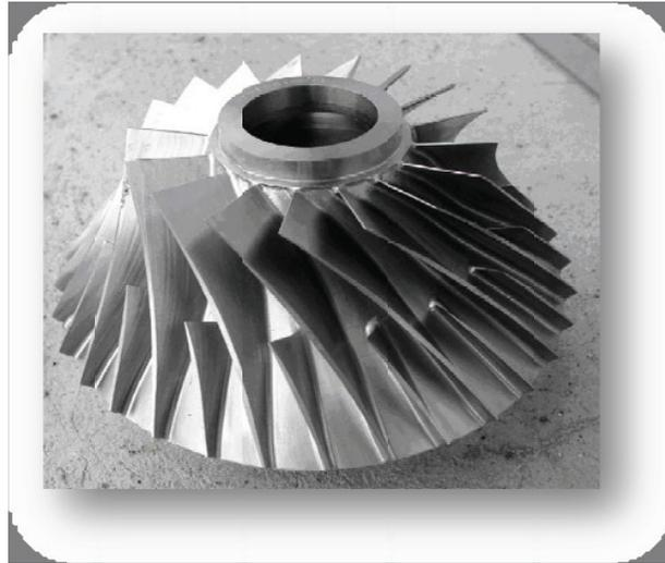
*Ilustración 28: Prototipo de titanio mecanizado en 5 ejes. Cortesía de la Fundación PRODINTEC.*
