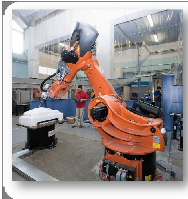
*Ilustración 30: Robot Kuka mecanizando la maqueta de un automóvil en el taller de PRODINTEC.*
