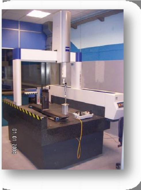
*Ilustración 45: MMC marca Zeiss modelo Contura G2, en las Instalaciones de la Fundación PRODINTEC.*
