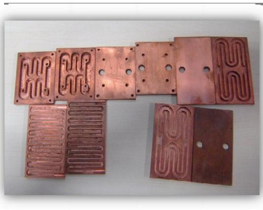
*Ilustración 57: Equipo laser de diodo para utilización médico – estética. Placas mecanizadas en las instalaciones del Fundación PRODINTEC, a través de centro de mecanizado por control numérico 5 ejes en alta velocidad.*
