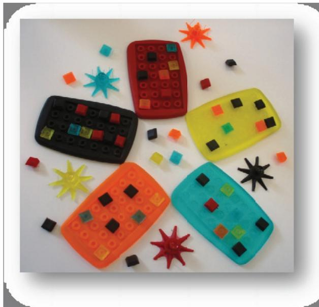
*Ilustración 37: Piezas plásticas coladas al vacío en diversas resinas plásticas*
