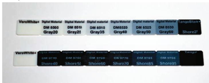
*Ilustración 20: Gama de 12 nuevos materiales digitales a partir de los materiales primitivos, Vero White plus y Tango Black plus, cortesía de Fundación PRODINTEC.*
