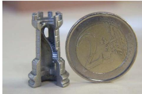
*Ilustración 8: Geometría interna compleja Cortesía de Fundación PRODINTEC.*
